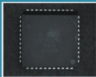
半球型光源检测效果：表面雷射刻字较不清晰
