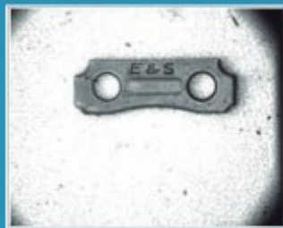
用低角度环型光源检测金属零件,表面凸字清晰
