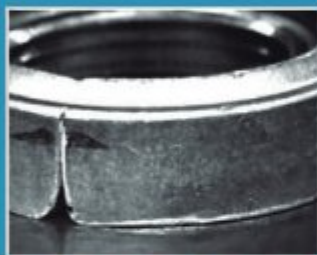
用红色环型光源测连接圈的破裂,明显表现特徵
