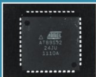
无影灯光源检测效果：IC脚位、表面雷射刻字清晰
